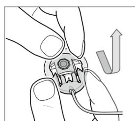
Ouvrir le raccord en pinçant les côtés du raccord du site et faire glisser vers l'arrière pour l'ouvrir complètement.
