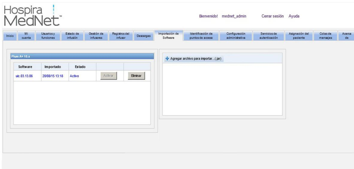
La vista de importación de software permite al usuario importar un archivo para cargar la nueva versión de software en el servidor. El proceso de actualización de software se inicia en el propio infusor.
