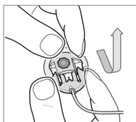
Aprire il connettore premendone i braccetti verso l'interno e facendolo scorrere per aprirlo completamente.
