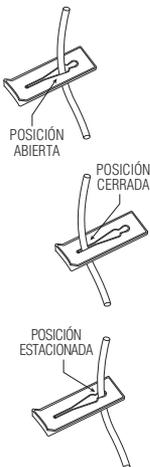
**Pinzas deslizantes** que pueden colocarse en cualquier punto de la tubería. La forma del corte permite tres posiciones de las pinzas:
